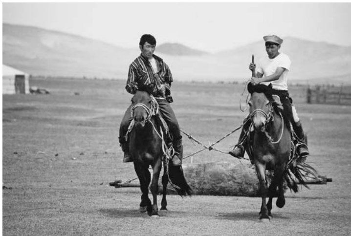
写真 12 ウマで羊毛を転がして縮重させる
