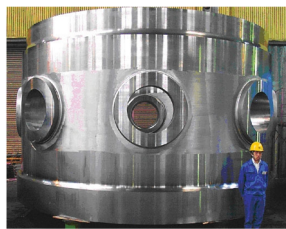
原子炉圧力容器フランジ (これに上下部分が付く)
